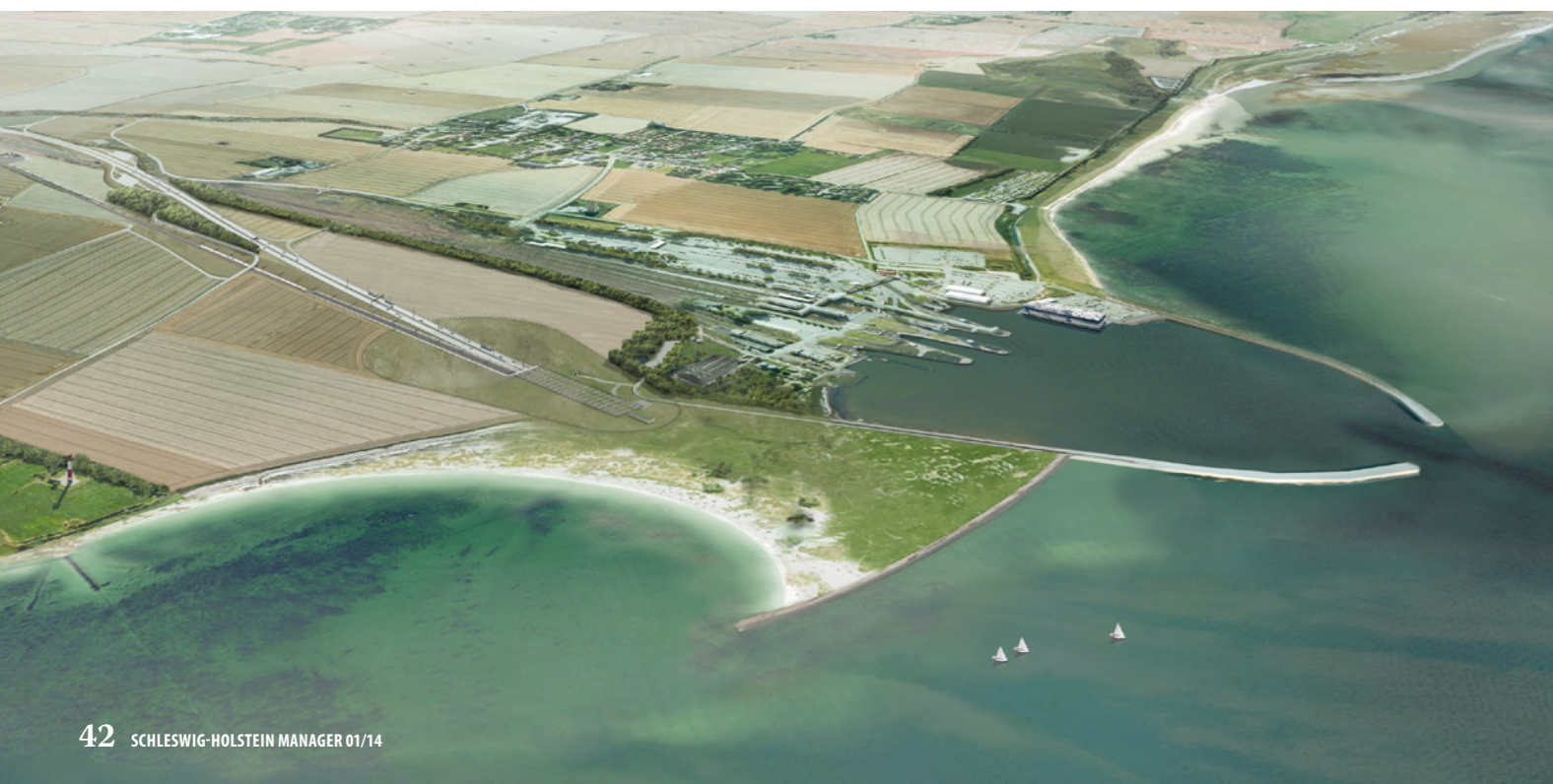
So soll der Tunnelleingang in Puttgarden einmal aussehen. Im Vordergrund wird es zu einer Neulandgewinnung durch Aushub kommen, direkt neben dem „alten“ Fährhafen mit der Mole.
